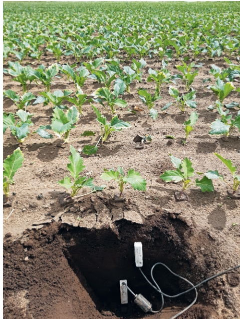
Abb. 9: Einbau von digitalen Bodenfeuchtesensoren
